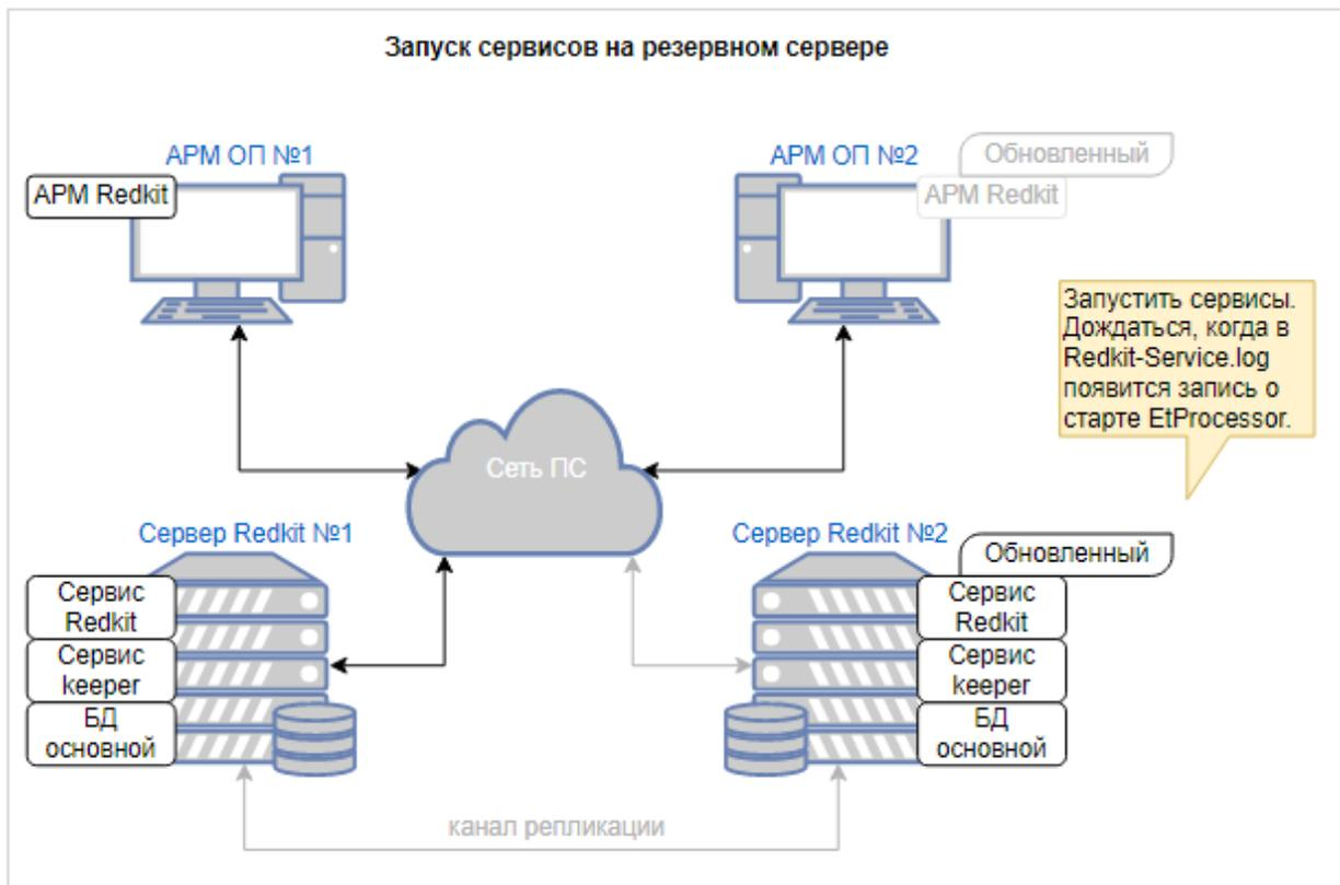
Рисунок 481 - Запуск сервисов на резервном сервере
