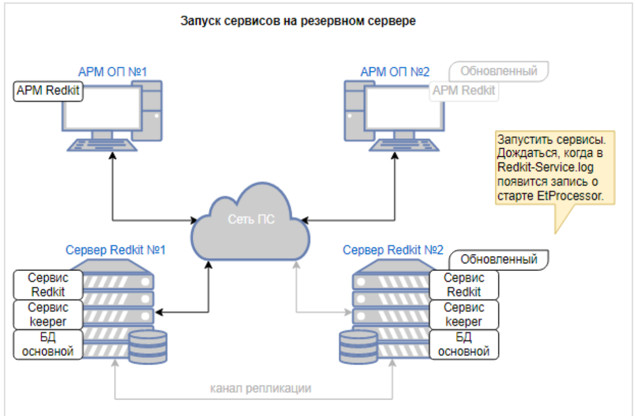
Рисунок 221 - Запуск сервисов на резервном сервере
