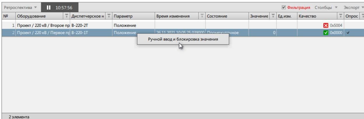
Рисунок 179 - Ручной ввод и блокировка значений
